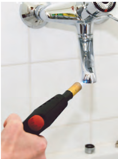
Vor der Entnahme einer Wasserprobe wird der Ausfluss abgeflammt, damit keine Keime aus dem Perlator das Ergebnis verfälschen.
