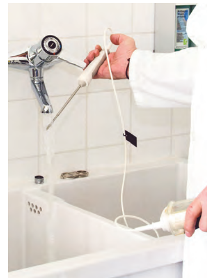
Um die mögliche Keimbelastung beurteilen zu können, wird auch die Temperatur des Wassers genau gemessen.
